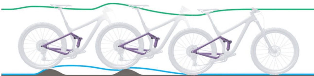
Obr. 223: Příliš pomalé roztahování tlumiče zadního odpružení
