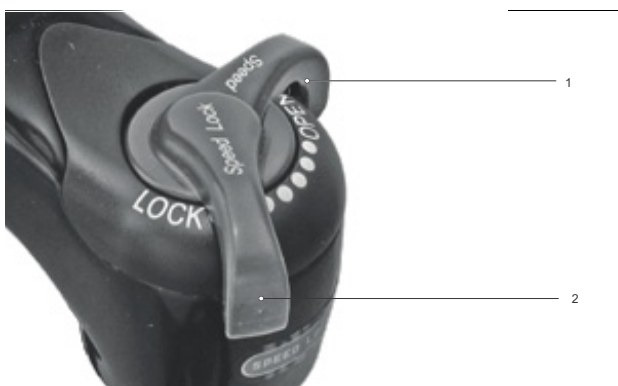
Obr. 204: Měkké nastavení nastavovacího šroubu komprese
