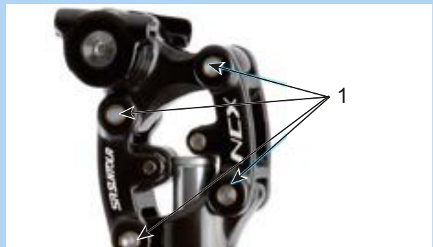
Obr. 195: Mazací body odpružené sedlovky SR SUNTOUR
