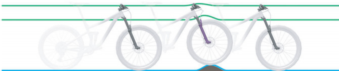
Obr. 11: Optimální chování vidlice při jízdě u nerovnosti
