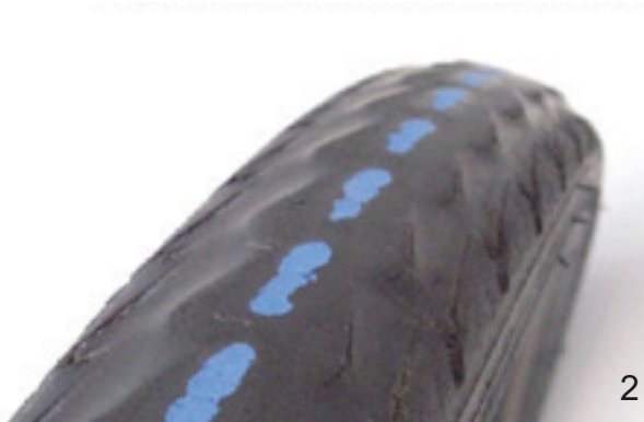
Obr. 162: Plášť bez profilu, který může být vyměněn (1), a plášť s proraženou ochranou (2), který je třeba vyměnit
