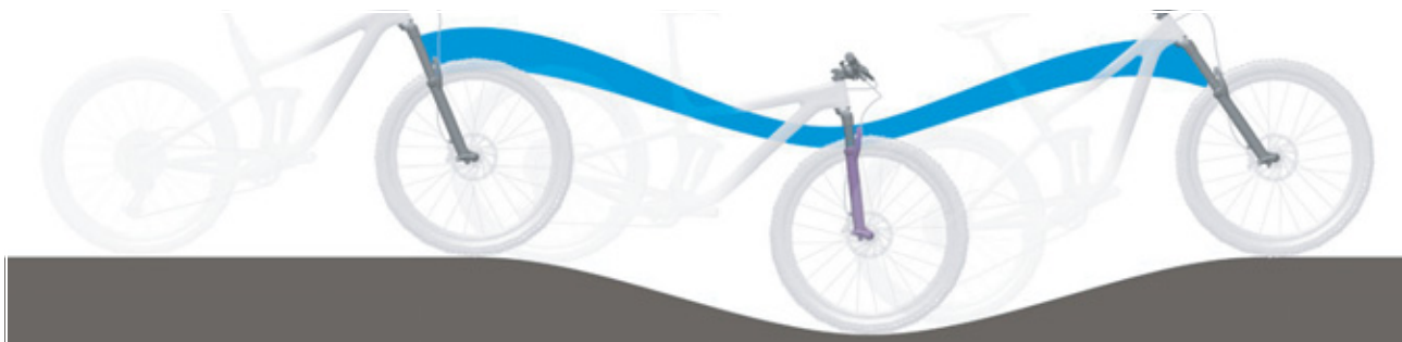
Obr. 209: Příliš měkké odpružení odpružené vidlice v horách
