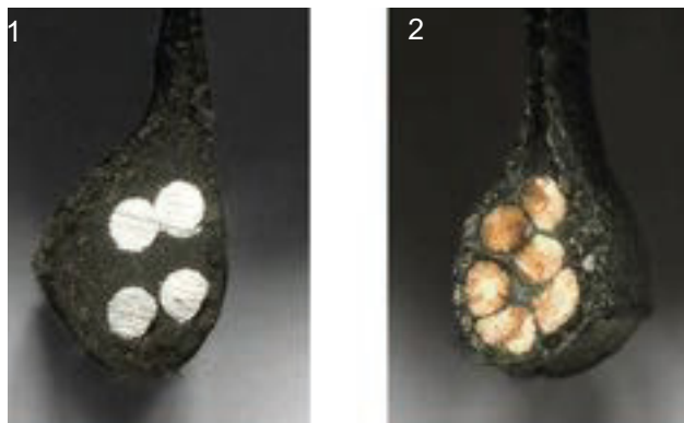
Obr. 19: Ocelová patka (1) a kevlarová patka (2)
