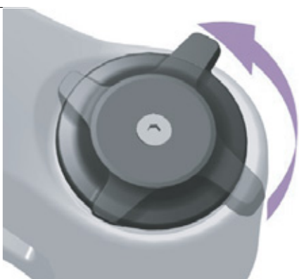
Obr. 212: Měkčí nastavení nastavovacím šroubem komprese
