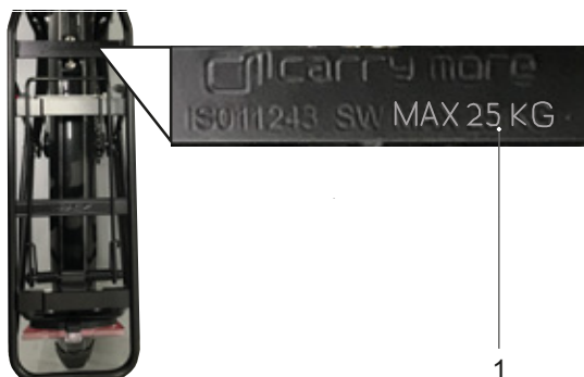
Obr. 139: Na nosiči zavazadel je uvedena jeho maximální nosnost (1)
