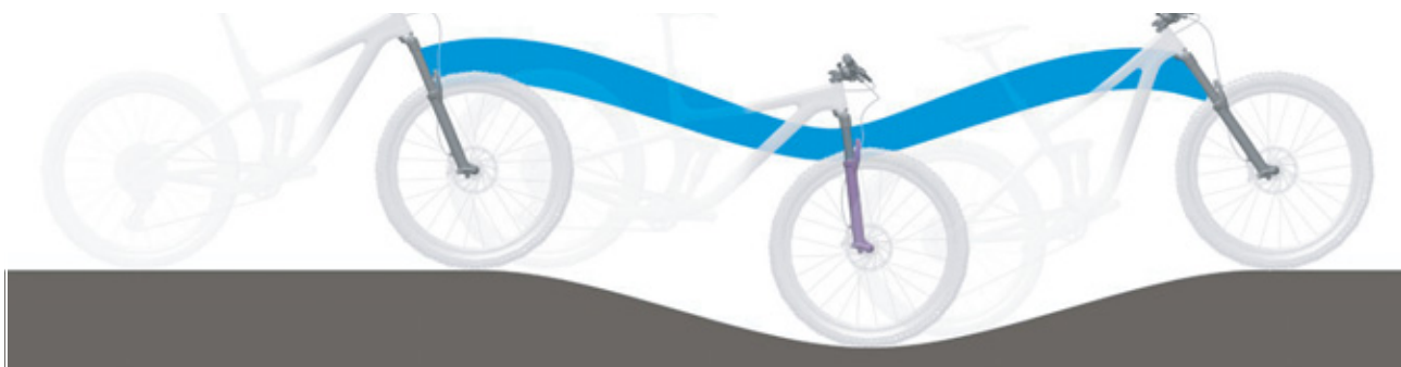
Obr. 10: Optimální chování vidlice při jízdě v kopcovitém terénu
