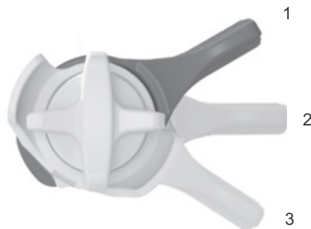
Illustration 79 : Dispositif de réglage de la compression FOX sur l'amortisseur arrière avec les positions OUVERT (1), MOYEN (2) et DUR (3)
