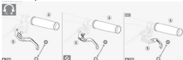
Illustration 57 : Régler la garde d'un levier de frein à disque Magura
