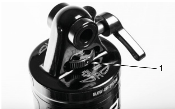
Illustration 63 : Molette de réglage de la détente Suntour (1) sur l'amortisseur arrière
