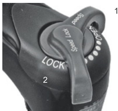
Illustration 75 : Dispositif de réglage de la compression Suntour avec les positions OPEN (1) et LOCK (2)
