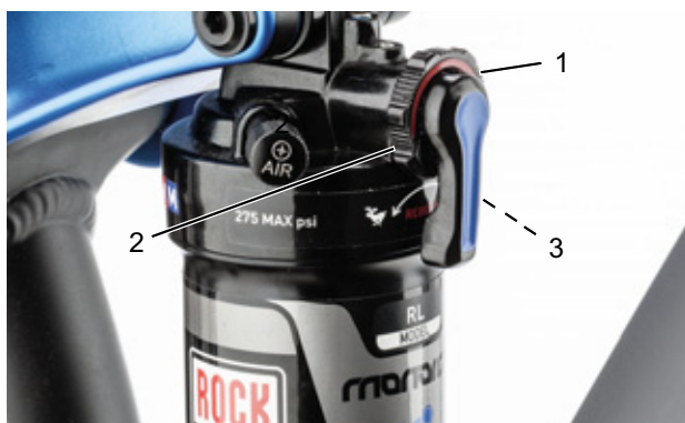
Illustration 81 : Régler la dureté de l'amortisseur de détente (1) de l'amortisseur arrière
