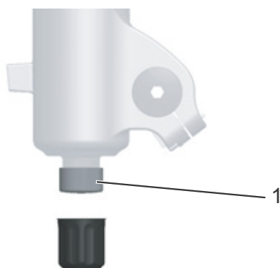
Illustration 62 : Dispositif de réglage de la détente FOX (1) sur l'extrémité de fourche
