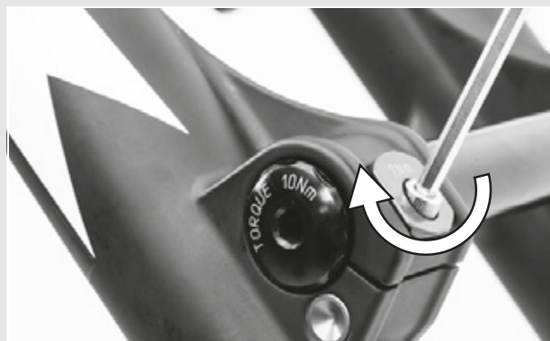
Illustration 25 : Serrer le collier de blocage
