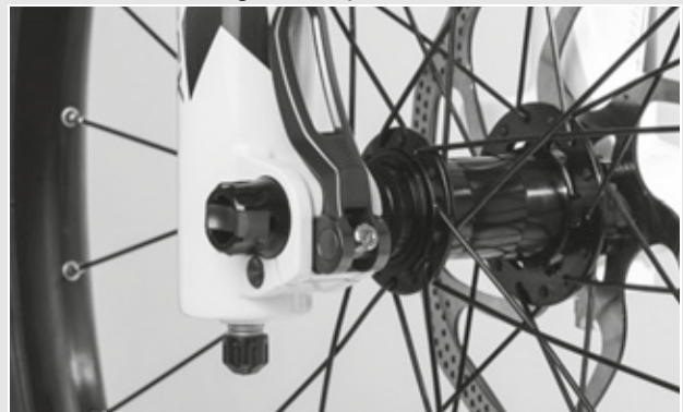
Illustration 75 : Régler la force de serrage de l'attache rapide
