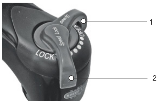
Paveikslėlis 79: „Suntour“ kompresiniai slopintuvai atviroje (1) ir uždaroje (2) padėtyje
