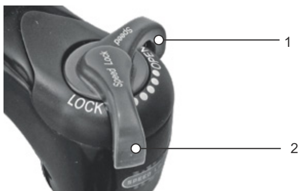
Paveikslėlis 77: „Suntour“ kompresiniai slopintuvai atviroje (1) ir uždaroje (2) padėtyje
