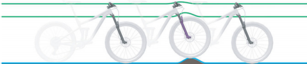
Paveikslėlis 7: Optimali šakių važavimo charakteristika nelygumuose
