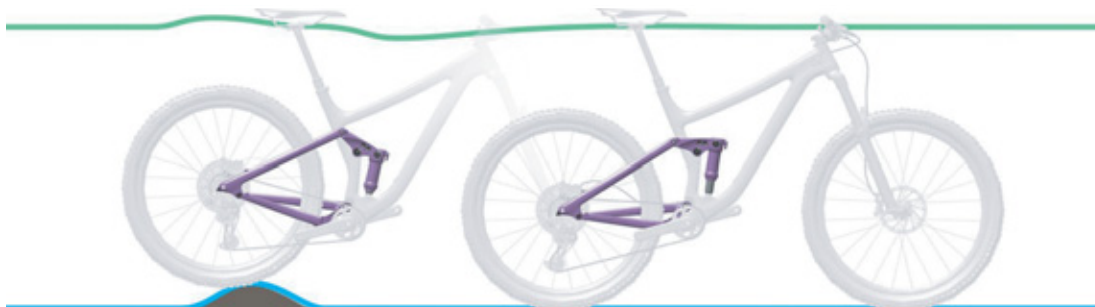
Paveikslėlis 12: Optimali galinio amortizatoriaus važiavimo charakteristika nelygumuose
