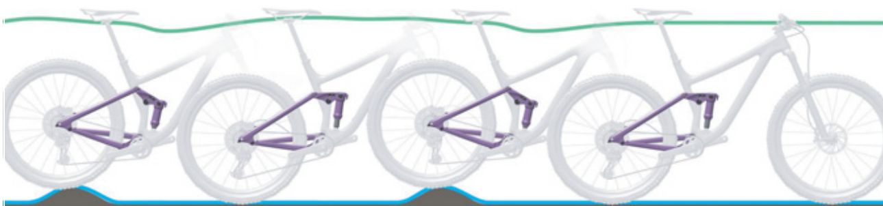
Paveikslėlis 49: Optimali galinio amortizatoriaus važiavimo charakteristika
