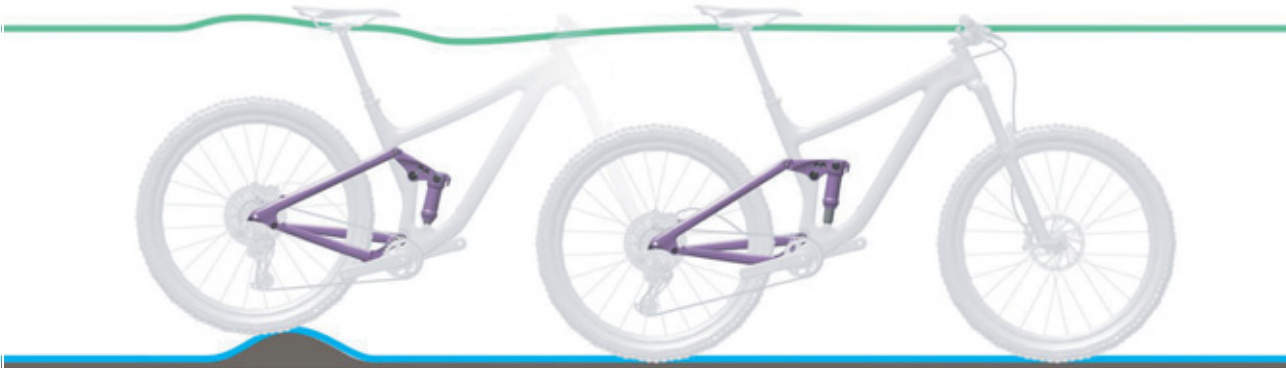
Paveikslėlis 55: Optimali galinio amortizatoriaus važiavimo charakteristika nelygumuose
