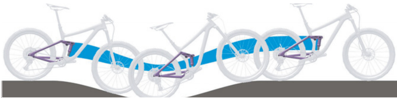
Paveikslėlis 84: Ant kalno galinio amortizoriaus amortizavimas per minkštas
