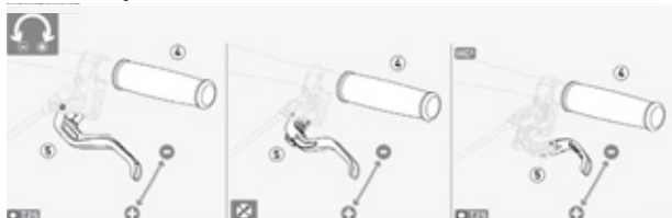
Paveikslėlis 43: „Magura“ diskinių stabdžių svirties atstumo iki vairo rankenos nustatymas
