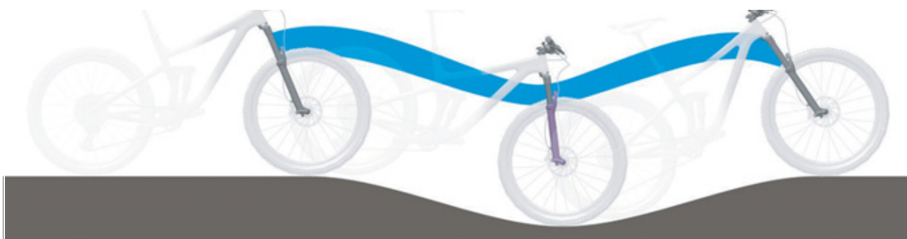
Paveikslėlis 6: Optimali šakių važavimo charakteristika kalvotoje vietovėje
