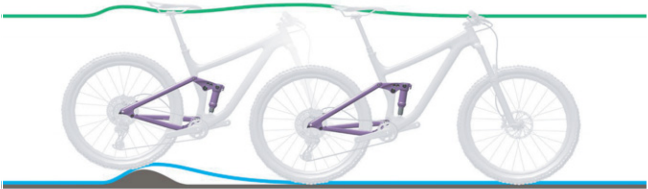
Paveikslėlis 86: Per kietas galinio amortizatoriaus amortizavimas nelygumuose
