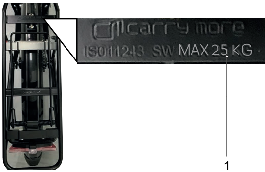
Abbildung 178: Auf dem Gepäckträger ist seine maximale Tragfähigkeit (1) ausgewiesen.
