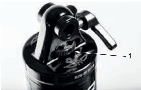
Abbildung 258: SR SUNTOUR-Zugstufen-Einsteller Rad (1) am Hinterbau-Dämpfer
