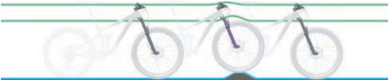
Abbildung 20: Optimales Fahrverhalten der Gabel bei Unebenheiten
