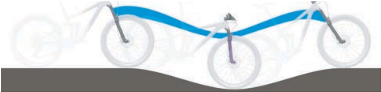
Abbildung 251: Zu weiche Federung der Federgabel am Berg
