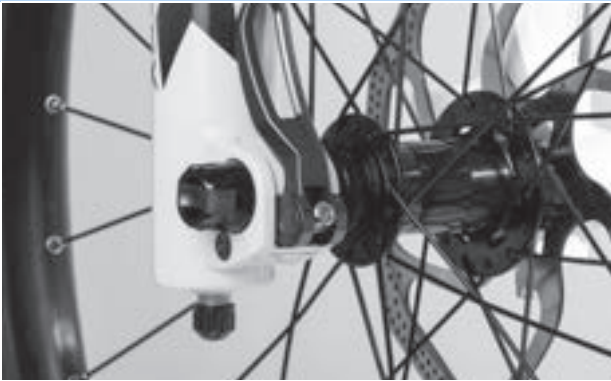
Abbildung 89: Perfekte Lage des Spannhebels
