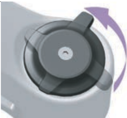
Abbildung 254: Druckstufen-Einsteller weicher einstellen
