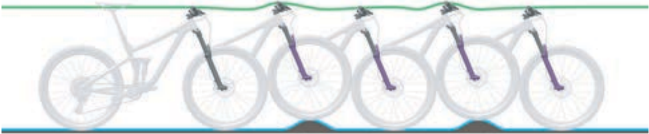
Abbildung 21: Optimales Fahrverhalten der Gabel
