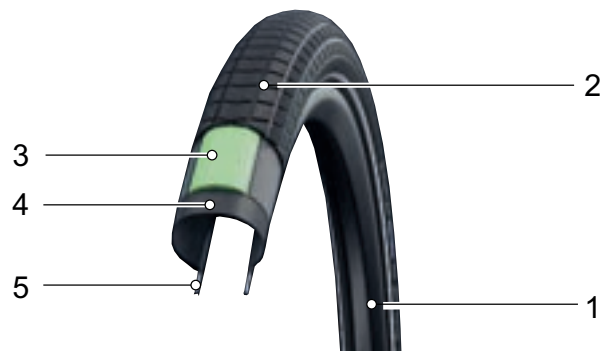
Abbildung 6: Aufbau offener Reifen
