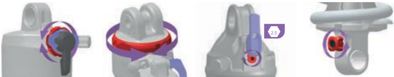
Abbildung 264: Lage und Form des Zugstufen-Einstellers (rot) ist Modellabhängig
