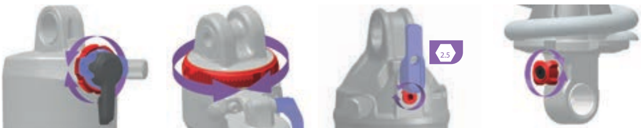
Abbildung 266: Lage und Form des Zugstufen-Einstellers (rot) ist Modellabhängig
