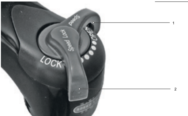
Abbildung 246: Druckstufeneinsteller weicher einstellen
