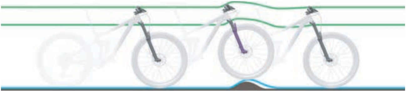
Abbildung 245: Zu harte Dämpfung der Federgabel bei Unebenheiten
