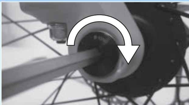
Abbildung 82: Achse in Pfeilrichtung anziehen
