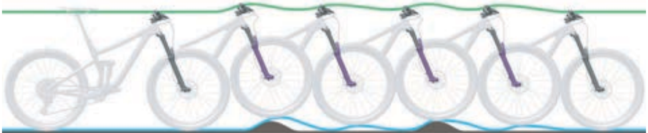
Abbildung 239: Zu schnelles Ausfedern der Federgabel
