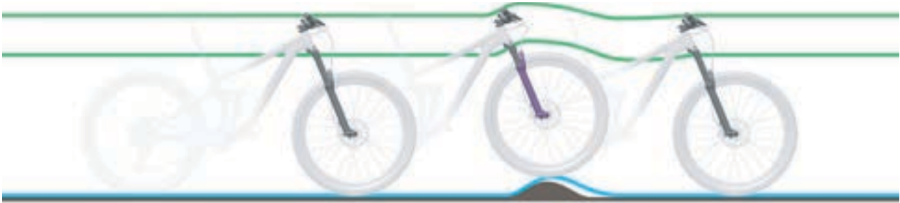
Abbildung 253: Zu harte Dämpfung der Federgabel bei Unebenheiten
