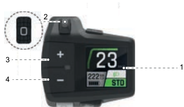
Abbildung 137: Bildschirm (1) am FIT Remote mit LCD
