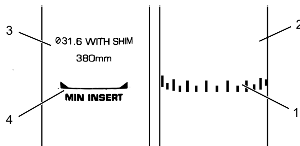
Abbildung 112: Detailansicht Sattelstützen, Beispiele für die Markierung der Mindesteinstecktiefe
