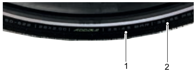
Abbildung 203: Fülldruck in bar (1) und psi (2)
