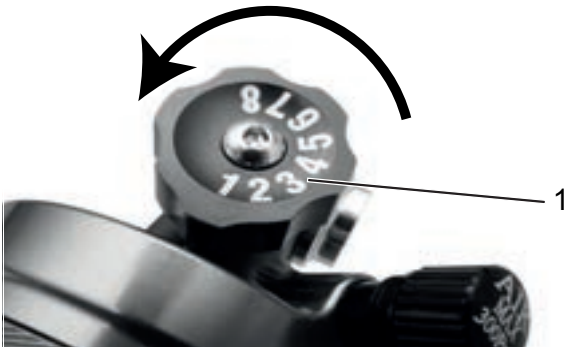
Abbildung 260: SR SUNTOUR-Druckstufeneinsteller (1) am Hinterbau-Dämpfer
