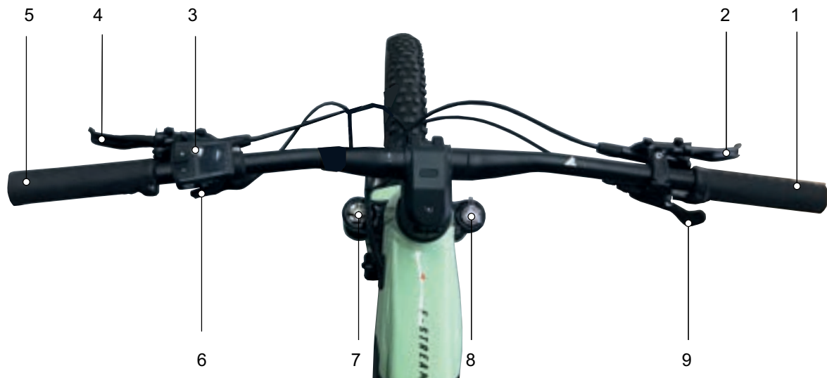
Abbildung 42: Detailansicht Lenker mit FIT Remote LCD Bordcomputer, Beispiel
