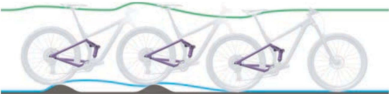
Abbildung 265: Zu langsames Ausfedern des Hinterbau-Dämpfers
