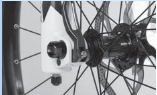
Abbildung 235: Spannkraft des Schnellspanners einstellen
