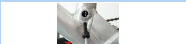
Illustration 159 : Desserrez l'axe Postpin
