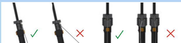
Illustration 183 : Câble Bowden correct et incorrect
