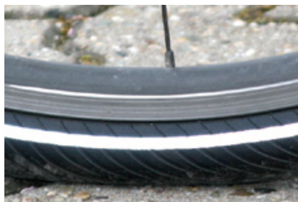
Illustration 100 : Pression correcte. Le pneu se déforme à peine sous le poids du corps
