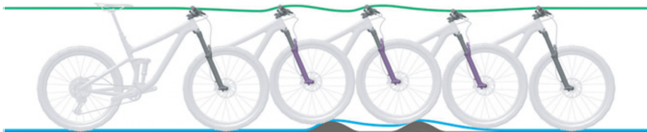
Illustration 220 : Détente trop lente de la fourche suspendue
