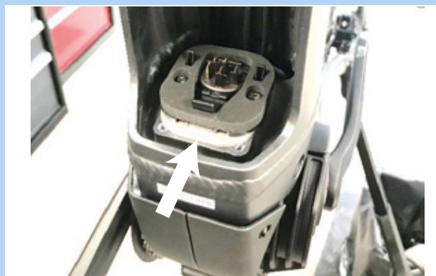
Illustration 54 : Plaques adaptatrices montées
