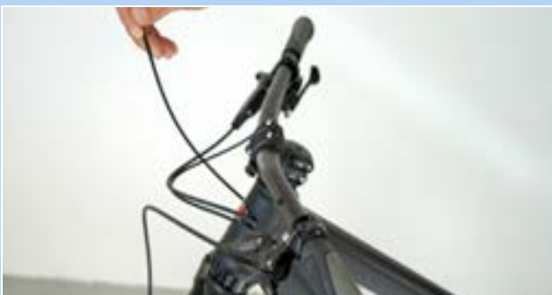
Illustration 215 : Accrocher le capuchon d'extrémité
