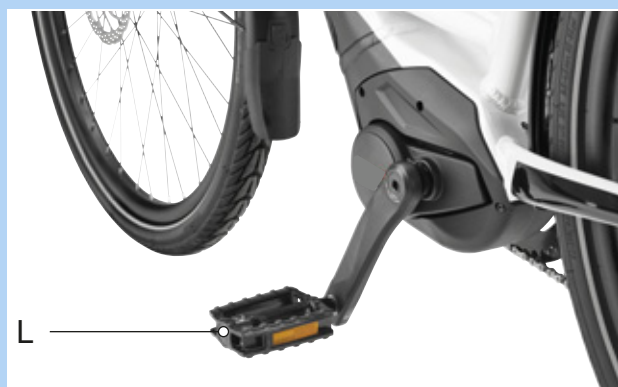
Illustration 80 : Pédale L dans le bras de manivelle gauche
