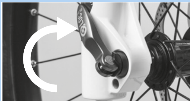
Illustration 78 : Fermer l'attache rapide
