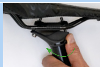
Illustration 212 : Fermer le réglage de la hauteur
