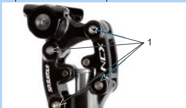
Illustration 155 : Points de lubrification de la tige de selle suspendue SR Suntour
