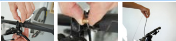
Illustration 195 : Détacher la télécommande
