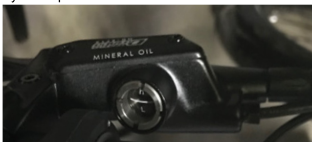
Illustration 6 : Hublot de contrôle du niveau d'huile
