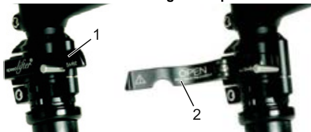
Illustration 27 : Levier de serrage de la potence fermé (1) et ouvert (2), exemple d'un by.schulz speedlifter
