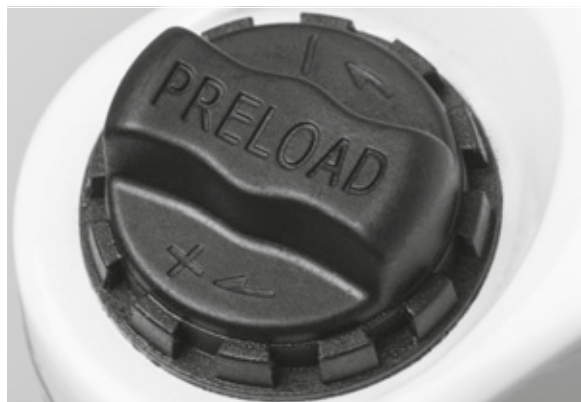
Illustration 29 : Molette de réglage de la course de suspension négative sur la couronne de la fourche de suspension
