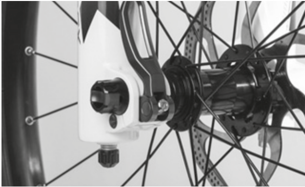
Illustration 39 : Régler la force de serrage de l'attache rapide
