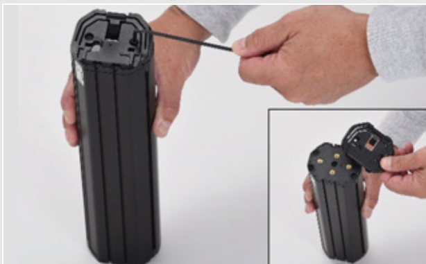
Paveikslėlis 36: Viršutinės sąsajos išmontavimas
