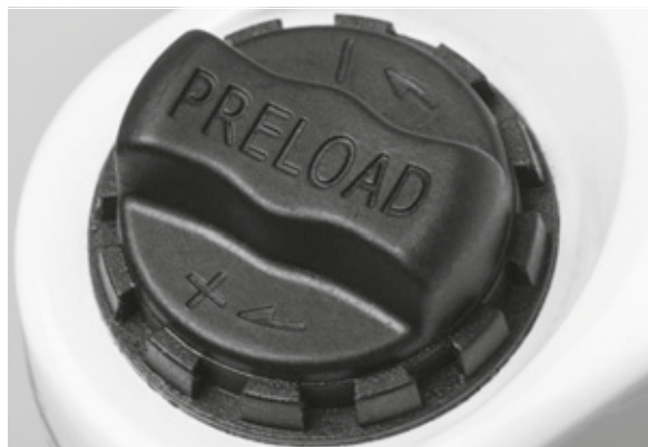
Paveikslėlis 71: Neigiamos amortizatorių eigos nustatymo ratukas ant amortizuojančių šakių karūnėlės
