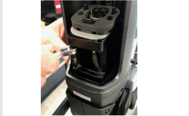
Paveikslėlis 28: 4 mm šešiabriaunių varžtų nuėmimas
