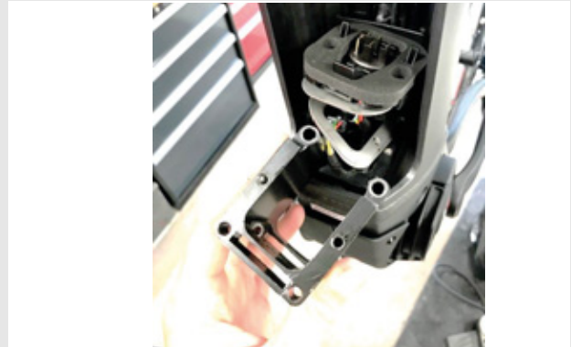
Paveikslėlis 30: „PowerTube Adapter“ ištraukimas
