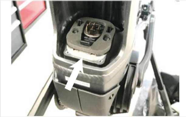
Paveikslėlis 31: Įmontuotos adapterio plokštelės
