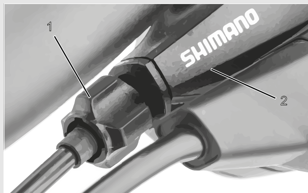
Paveikslėlis 103: Reguliavimo įvorė (1) vieno praėjimo kabeliu valdomam pavarų perjungimui su pavarų svirties korpusu (2), pavyzdys
