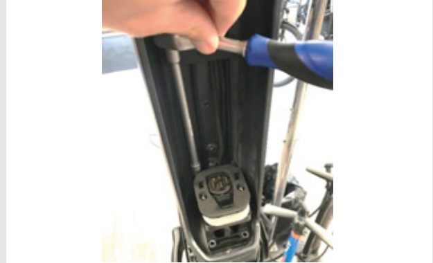
Paveikslėlis 29: Vidinių šešiabriaunių varžtų nuėmimas
