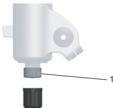
Paveikslėlis 74: FOX atšokimo laipsnio reguliatorius (1) ant šakės rato ašies griovelio
