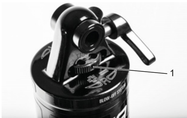
Paveikslėlis 75: „Suntour“ atšokimo pakopos reguliatoriaus ratas (1) ant galinio amortizatoriaus
