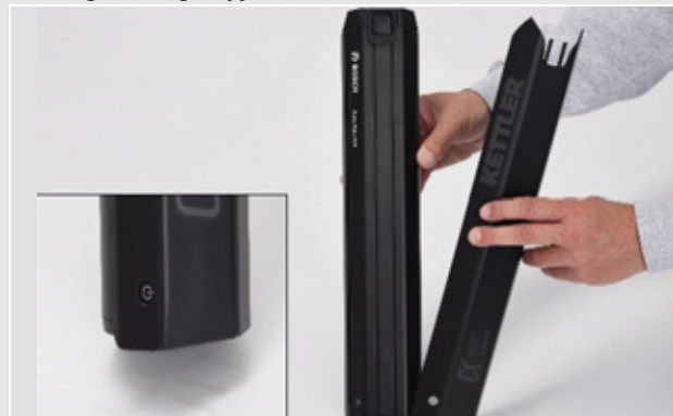
Paveikslėlis 35: Akumuliatoriaus dangtelio užstūmimas ant akumuliatoriaus
