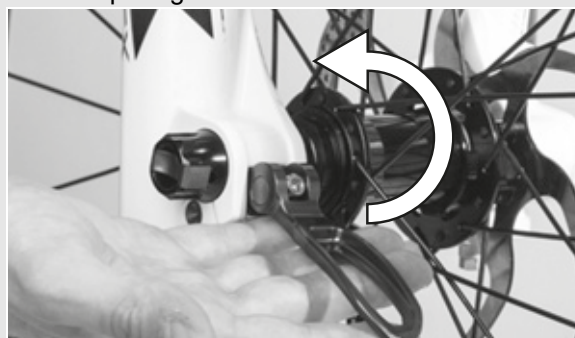
Paveikslėlis 49: Svirties užtvirtinimas
