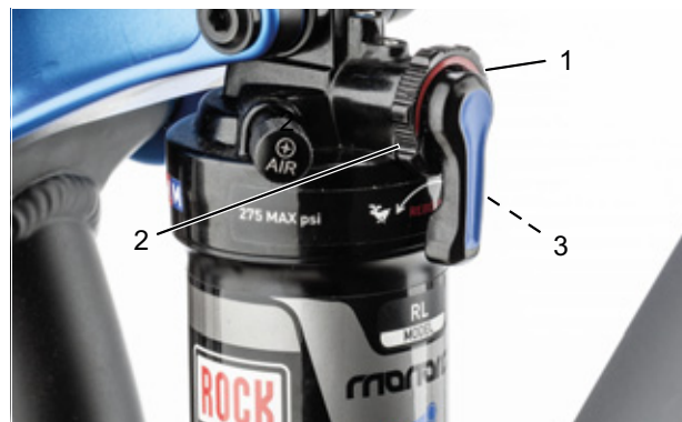
Paveikslėlis 96: Atšokimo amortizatoriaus nustatymas galinio amortizatoriaus nustatymo ratuku (1)
