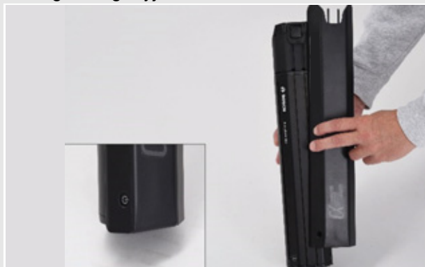
Paveikslėlis 39: Akumuliatoriaus dangtelio užstūmimas ant akumuliatoriaus
