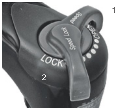
Figura 32: Regulador de niveles de presión Suntour con las posiciones OPEN (1) y LOCK (2)
