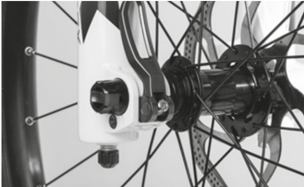
Figura 35: Ajuste de la fuerza de tensado del cierre rápido
