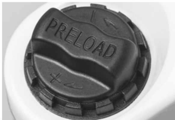
Figura 26: Rueda de ajuste del recorrido negativo de muelle en la corona de la horquilla de suspensión
