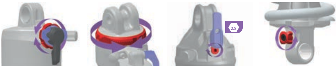
Abbildung 245: Lage und Form des Zugstufeneinstellers (rot) ist Modellabhängig
