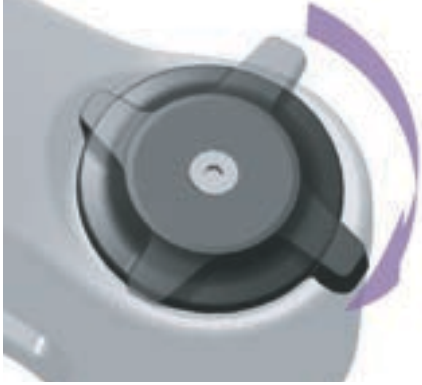
Abbildung 151: Druckstufeneinsteller härter einstellen
