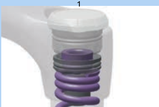
Abbildung 101: Vorspannungseinstellring hinein und heraus drehen.
