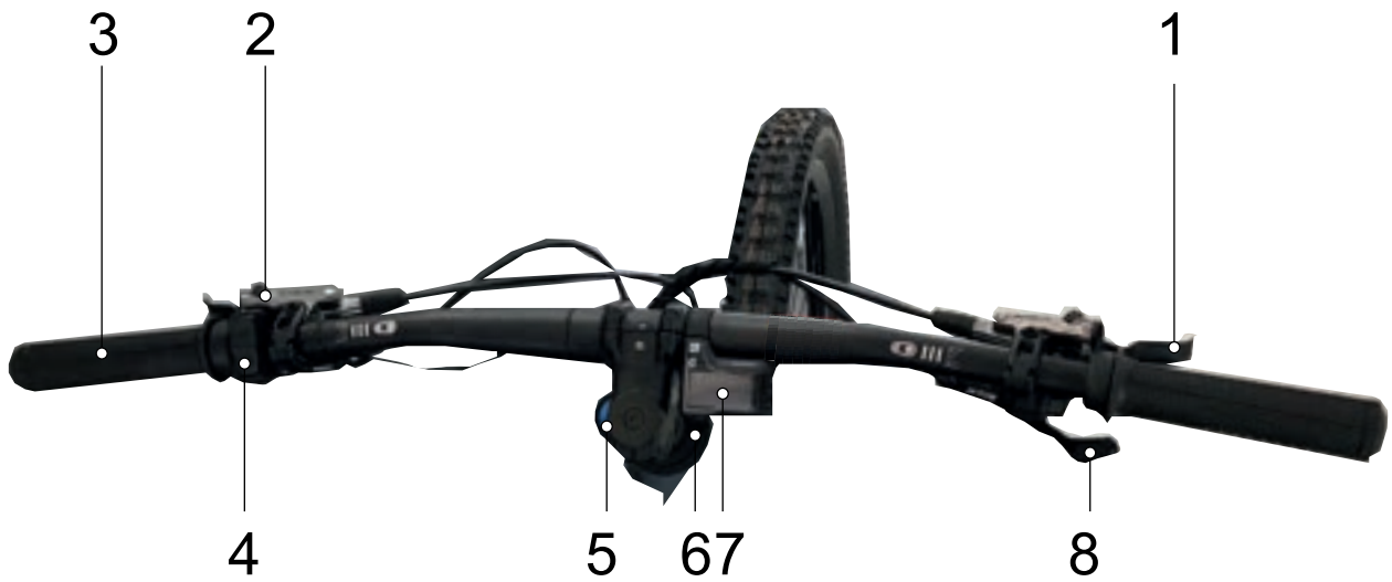
Abbildung 46: Detailansicht Lenker mit SHIMANO SC-E800 Bordcomputer, Beispiel
