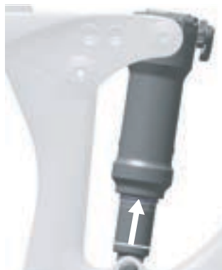
Abbildung 108: O-Ring am Hinterbau-Dämpfer verschieben
