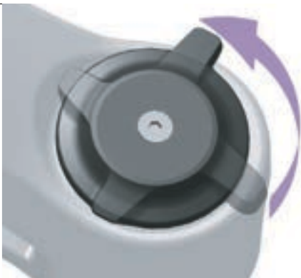
Abbildung 243: Druckstufeneinsteller weicher einstellen
