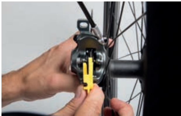
Abbildung 164: Bremsbelag im eingebauten Zustand mithilfe der Transportsicherung prüfen
