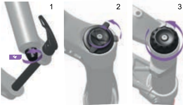
Abbildung 103: Zugstufe (1) und Druckstufendämpfer (2 und 3) öffnen
