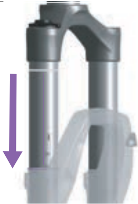
Abbildung 89: O-Ring an der Federgabel verschieben
