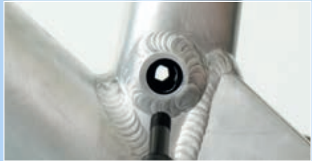
Abbildung 258: Loch der Postpin Schnittstelle
