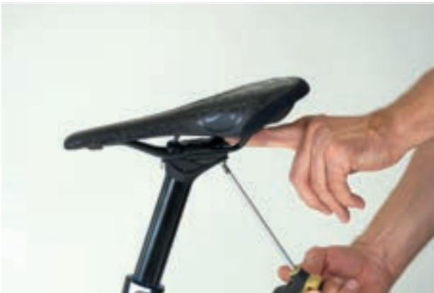
Abbildung 100: Hintere Schraube lockern
