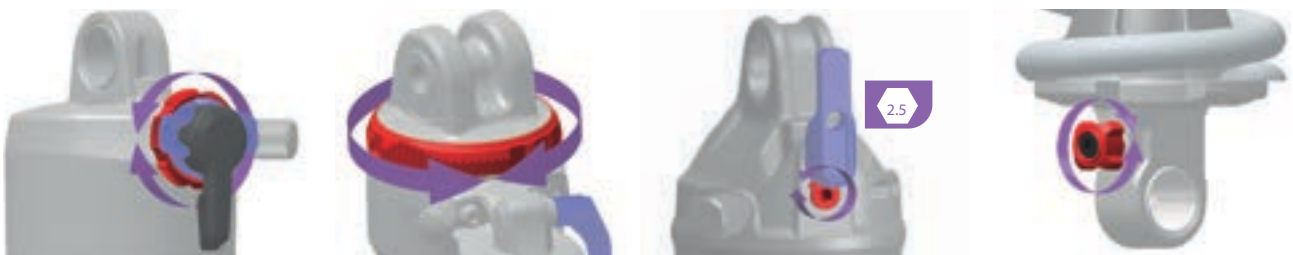
Abbildung 285: Lage und Form des Zugstufeneinstellers (rot) ist Modellabhängig
