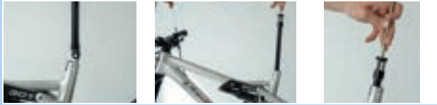
Abbildung 226: Kartusche Ventildeckel befestigen
