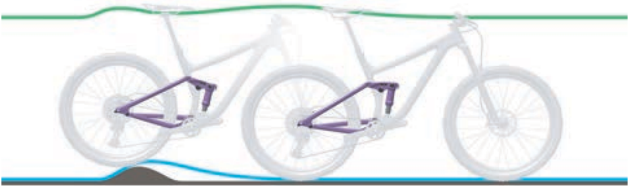
Abbildung 282: Zu harte Dämpfung des Hinterbau-Dämpfers bei Unebenheiten
