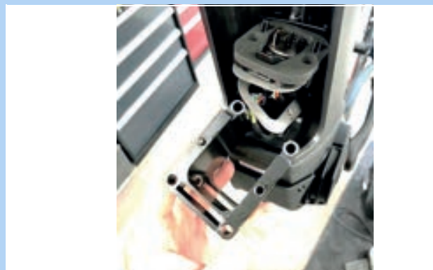
Abbildung 59: PowerTube Adapter herausziehen
