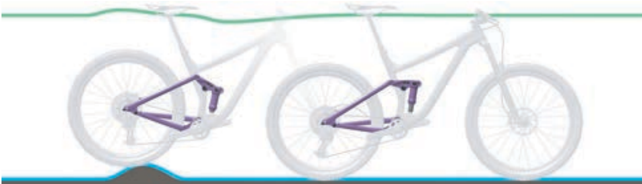
Abbildung 149: Optimales Fahrverhalten des Hinterbau-Dämpfers bei Unebenheiten
