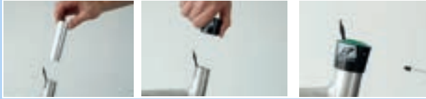
Abbildung 255: Gleitbuchse und Außenhülse einbauen
