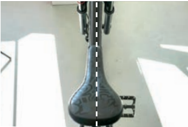
Abbildung 89: Sattel in Fahrtrichtung ausrichten
