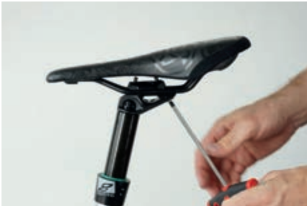
Abbildung 102: Hintere Schraube lockern
