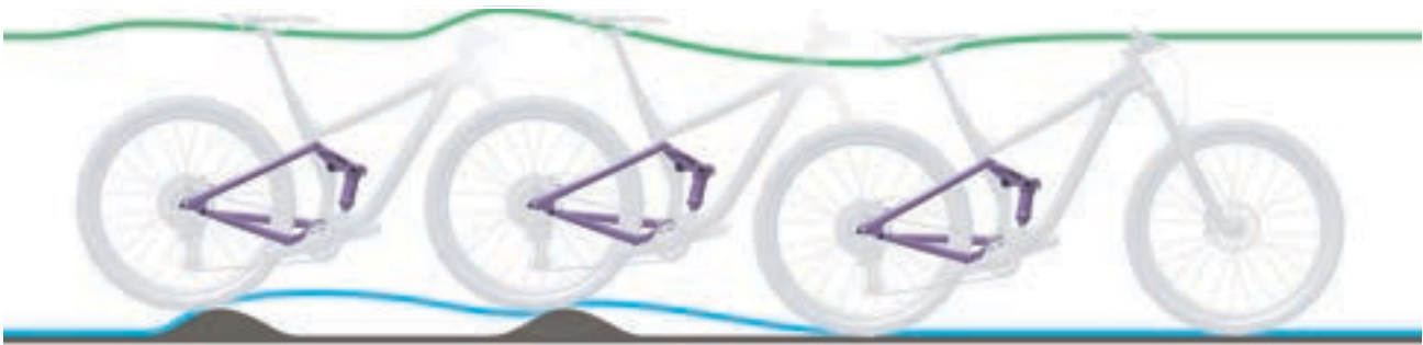
Abbildung 278: Zu langsames Ausfedern des Hinterbau-Dämpfers
