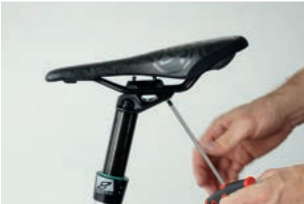
Abbildung 108: Hintere Schraube lockern
