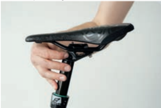
Abbildung 103: Sattelneigung am Einstellrad einstellen
