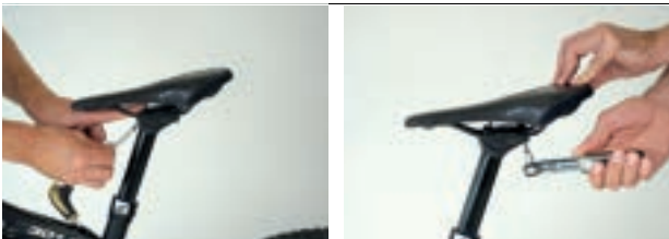
Abbildung 101: Vordere und hintere Schraube feststellen
