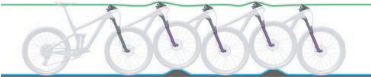
Abbildung 12: Optimales Fahrverhalten der Gabel
