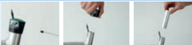
Abbildung 206: Außenhülse und Gleitbuchse ausbauen
