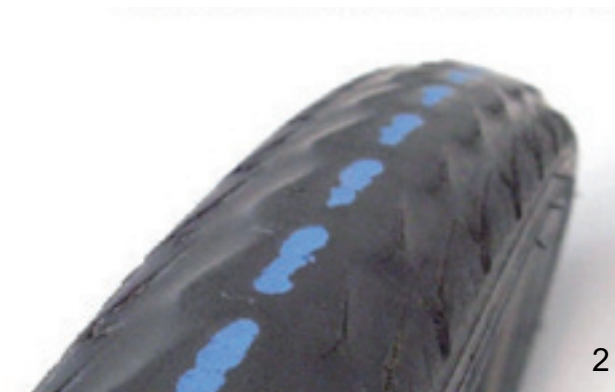
Abbildung 186: Reifen ohne Profil, der gewechselt werden kann (1), und Reifen mit durchscheinendem Pannenschutz (2), der gewechselt werden muss
