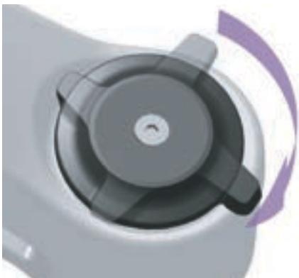
Abbildung 273: Druckstufeneinsteller härter einstellen
