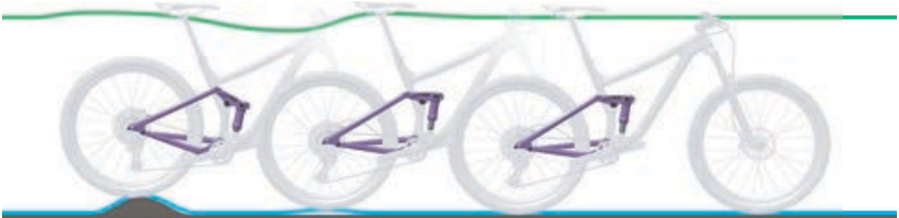
Abbildung 284: Zu schnelles Ausfedern des Hinterbau-Dämpfers
