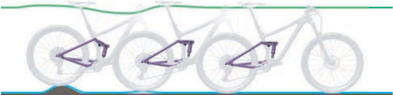
Abbildung 276: Zu schnelles Ausfedern des Hinterbau-Dämpfers
