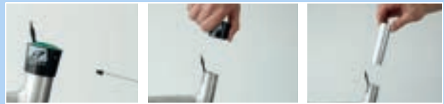
Abbildung 240: Außenhülse und Gleitbuchse ausbauen
