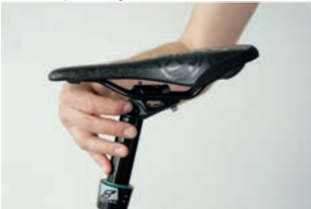
Abbildung 109: Sattelneigung am Einstellrad einstellen
