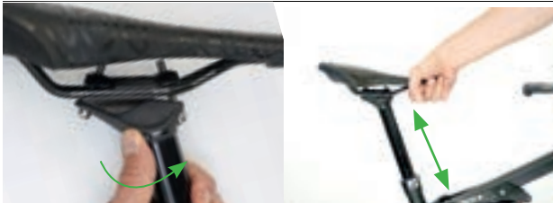
Abbildung 96: Höhe der Sattelstütze einstellen
