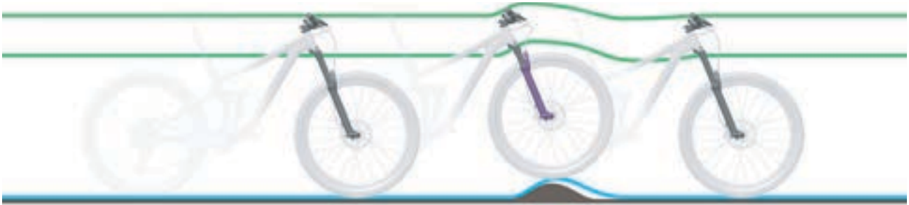
Abbildung 274: Zu harte Dämpfung der Federgabel bei Unebenheiten
