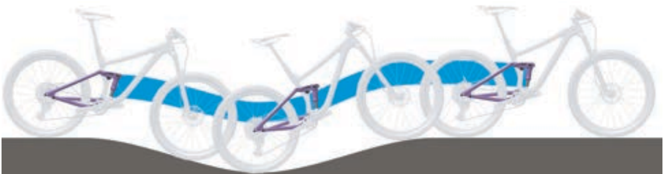
Abbildung 23: Optimales Fahrverhalten des Hinterbau-Dämpfers im hügeligen Gelände
