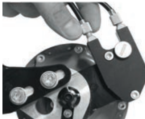
Abbildung 192: ROHLOFF-Naben Versionen mit externer Schaltansteuerung haben die Zugeinsteller an der Seilbox, die sich auf der linken Seite befindet
