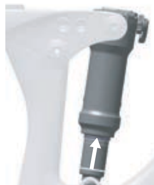
Abbildung 143: O-Ring am Hinterbau-Dämpfer verschieben
