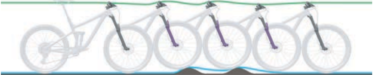
Abbildung 262: Zu langsames Ausfedern der Federgabel
