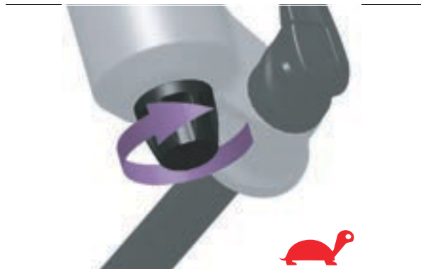
Abbildung 269: Zugstufen-Schraube in Richtung Schildkröte drehen
