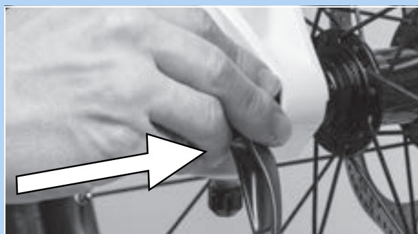
Abbildung 82: Schnellspanner in Pfeilrichtung einschieben
