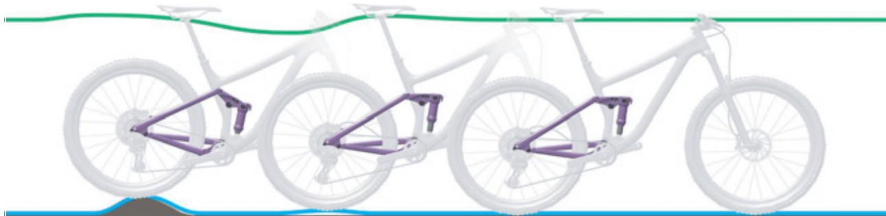
Rysunek 279: Zbyt szybkie rozprężanie się tylnego amortyzatora
