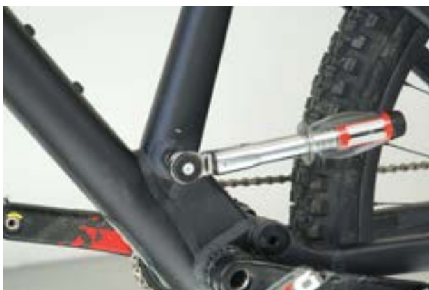
Rysunek 89: Dociąganie osi sztycy podsiodłowej
