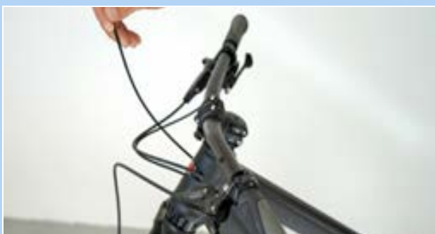
Rysunek 252: Zaczepianie zaślepki
