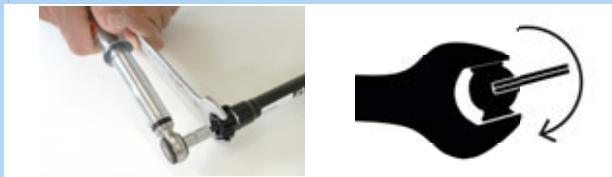
Rysunek 215: Regulacja zgodnie z ruchem wskazówek zegara
