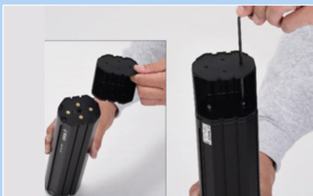
Rysunek 65: Montaż przedłużenia PowerTube
