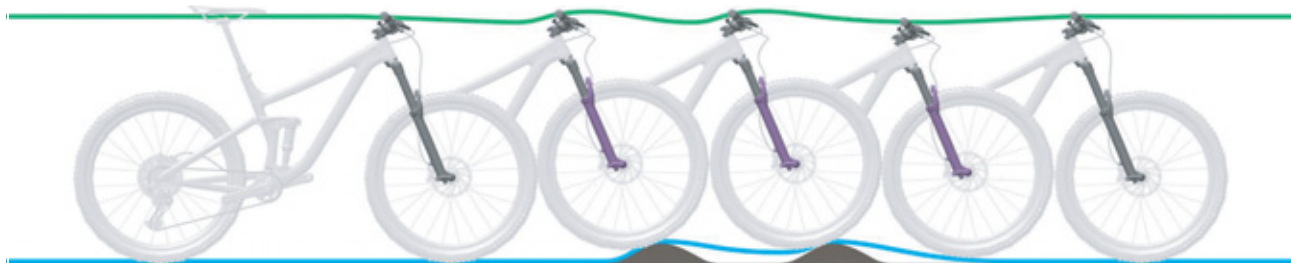
Rysunek 265: Zbyt wolne rozprężanie widelca amortyzowanego
