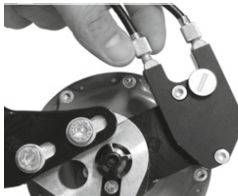
Rysunek 186: Wersje piast Rohloff z zewnętrznym sterowaniem zmiany biegów mają regulator linki na przepustnicy kablowej, która znajduje się po lewej stronie
