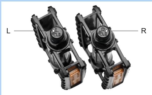
Rysunek 84: Przykład oznakowania pedałów
