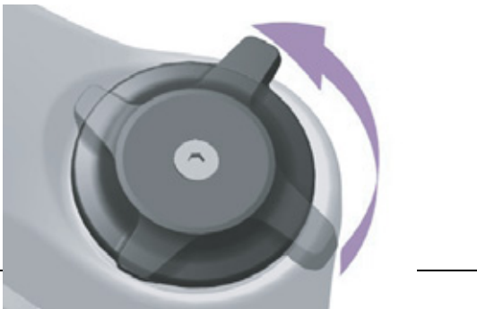
Rysunek 172: Ustawienie nastawnika dobiecia na bardziej miękki tryb pracy
