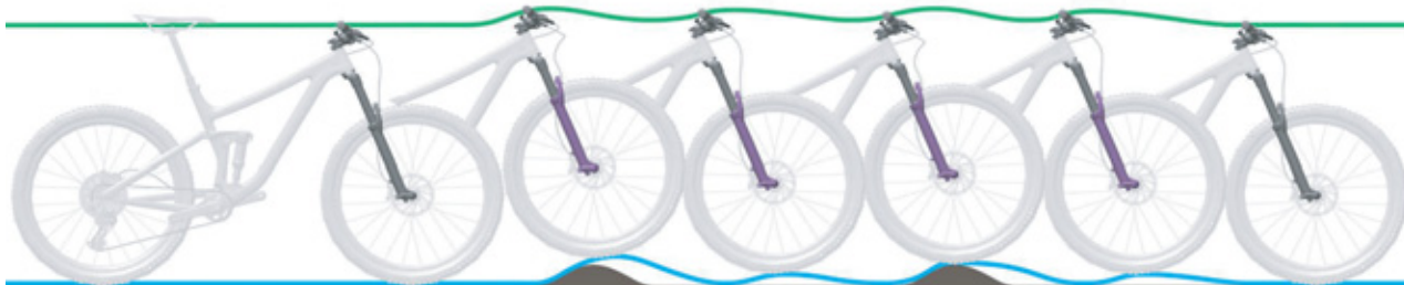
Rysunek 263: Zbyt szybkie rozprężanie widelca amortyzowanego
