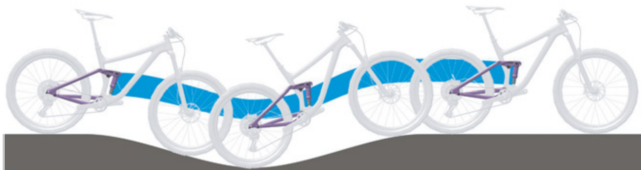
Rysunek 17: Optymalne działanie tylnego amortyzatora na pagórkowatym terenie
