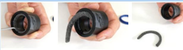
Rysunek 239: Wyciąganie pierścienia filcowego
