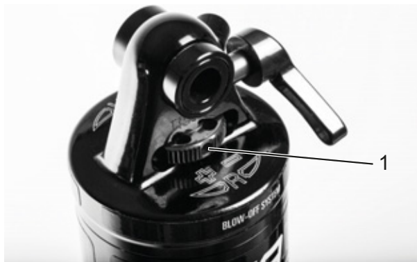
Rysunek 272: Nastawnik odbicia koła Suntour (1) na tylnym amortyzatorze
