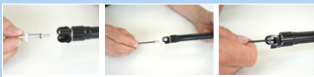
Rysunek 212: Mocowanie nakrętki zaworu wkładu
