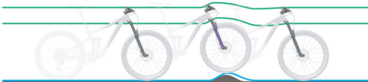
Rysunek 261: Zbyt twarde tłumienie widełca amortyzowanego na nierównościach
