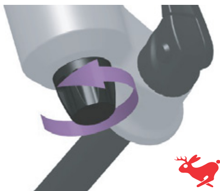
Rysunek 266: Obrócić pokrętko nastawnika odbicia w kierunku symbolu zająca
