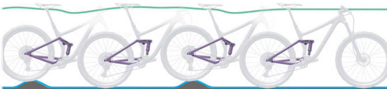
Rysunek 21: Optymalne działanie tylnego amortyzatora
