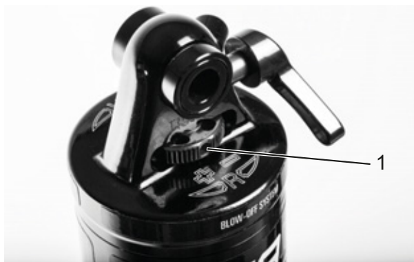
Rysunek 274: Nastawnik odbicia koła Suntour (1) na tylnym amortyzatorze
