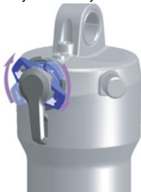
Rysunek 149: Ustawienie nastawnika dobicia na twardszy tryb pracy
