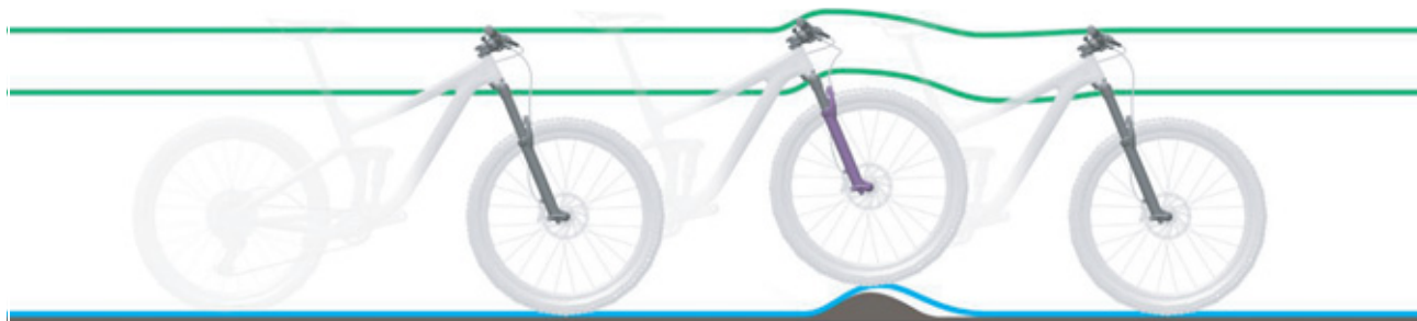
Rysunek 269: Zbyt twarde tłumienie widelca amortyzowanego na nierównościach
