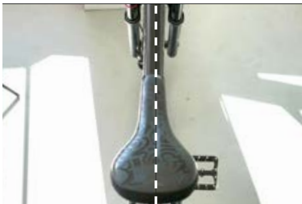
Rysunek 88: Ustawianie siodełka zgodnie z kierunkiem jazdy
