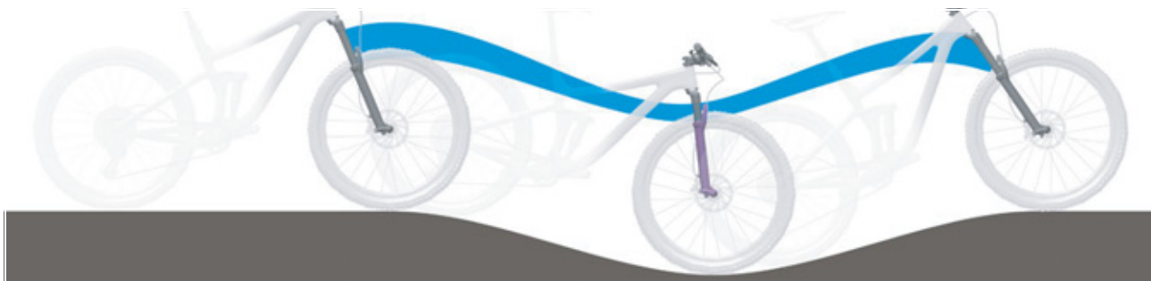
Rysunek 267: Zbyt miękkie amortyzowanie widelca na wzniesieniu
