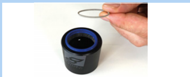
Rysunek 202: Wyciągnięty pierścień sprężysty
